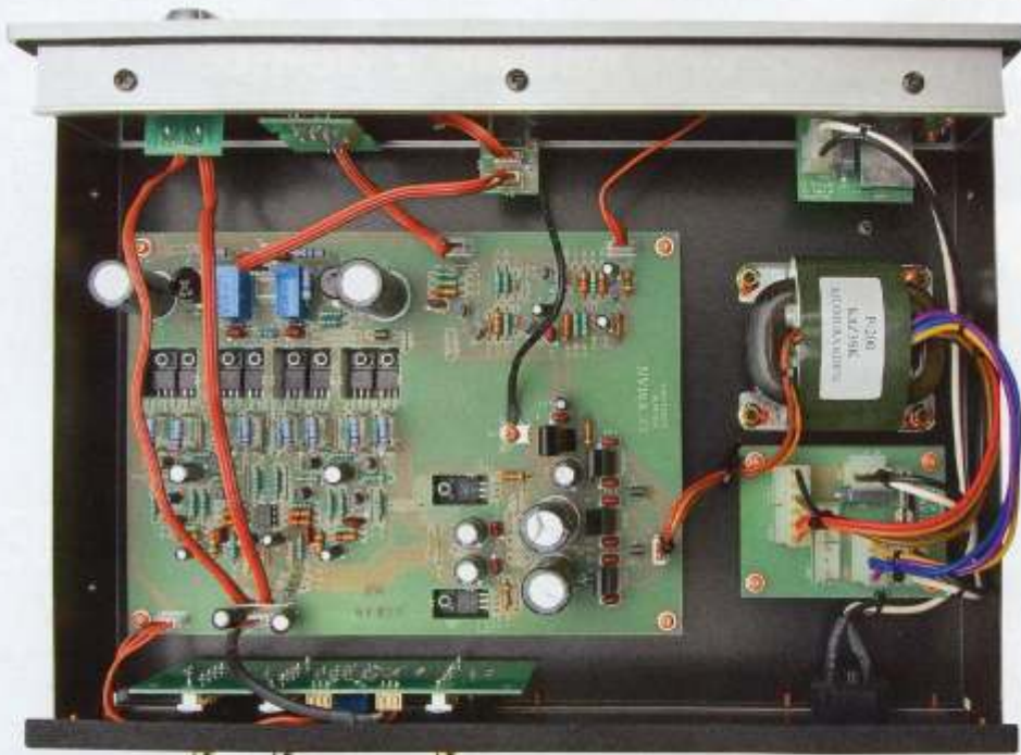
Układ zmontowano na kilku płytkach. Najważniejsza jest ta pośrodku, z układem wzmacniającym i zasilaczem. Tranzystory przykręcono bezpośrednio do dna obudowy.
